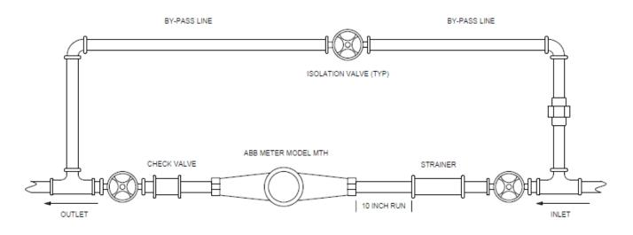
NOTE: ALLOW 10" MINIMUM STRAIGHT RUN ON INLET SIDE
